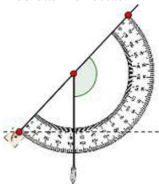
Simplemente se necesita un tubo fino de cartón, o una varilla hueca, un transportador, un trozo de cordel y algún objeto que haga las veces de plomada, por ejemplo una goma de borrar.
